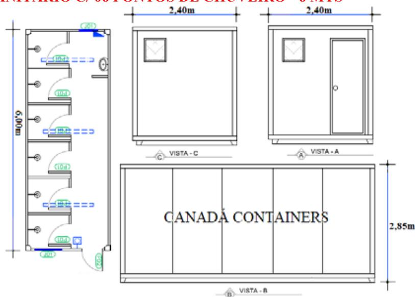
Módulo Metálico tipo Habitacional, Modelo ISOMODULO–**Sanitário Termo Acústico**
